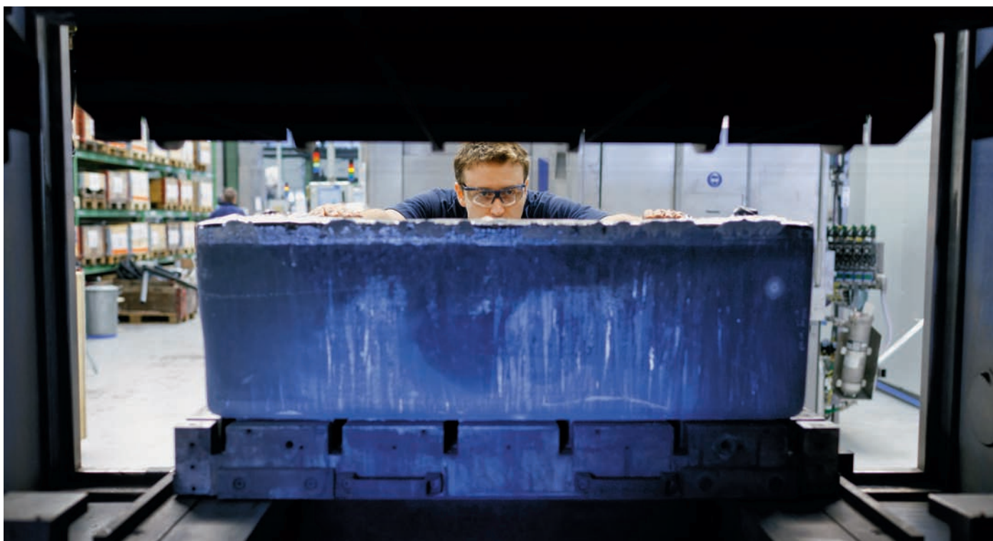
Technical Support Process Engineer Michael Bürki von MB Wafertec belädt die Bricking-Säge mit einem Siliziumblock.
